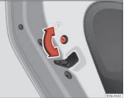
Fig. 21 Childproof lock on the left hand side door
