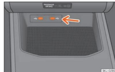
Fig. 135 Centre console: USB input.
