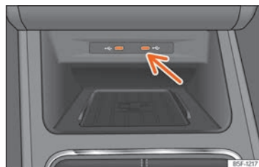
Fig. 145 Centre console: USB port.
