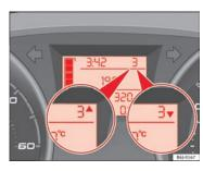
Fig. 32 Gear display
