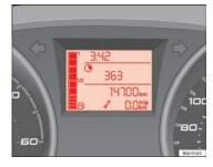
Fig. 36 Service interval display
