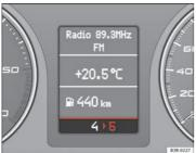
Fig. 50 Gear display
