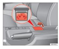
Fig. 137 Centre console: 230 volt socket
