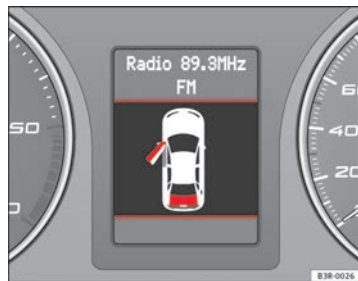
Fig. 51 Display: door catch/tailgate warning
