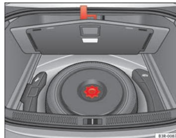
Fig. 182 Spare steel rim wheel
