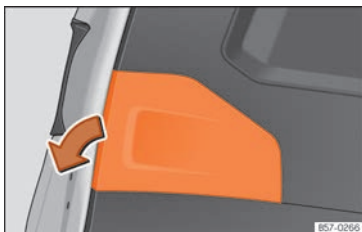
Fig. 201 Rear lid open: remove the lid.
