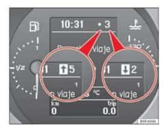
Fig. 38 Gear display
