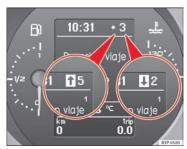
Fig. 39 Gear display
