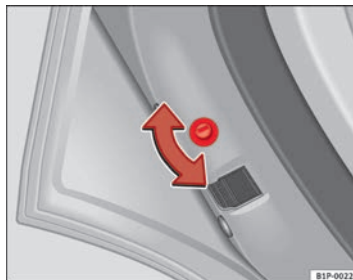
Fig. 59 Childproof lock on the left hand side door
